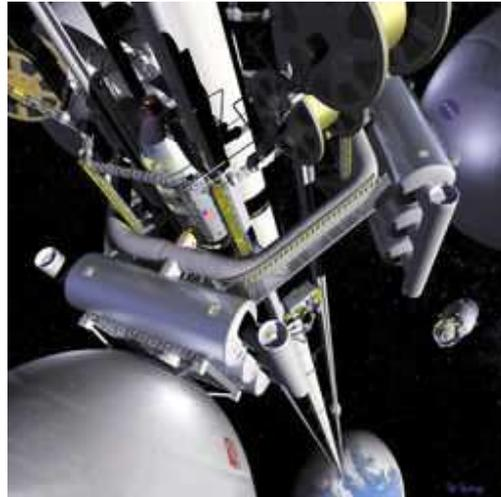
*Figura 2.18. Los científicos se proponen lanzar un satélite estático al espacio a 36,000 kilómetros sobre el ecuador de la Tierra y desde el satélite estático baja un cable de nanomaterial. Aprovechando este cable, se instalará un ascensor para subir y bajar, de manera que esté hecha una nave espacial tipo ascensor.*
